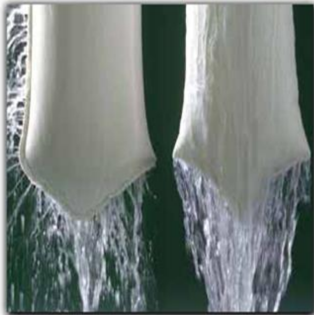
Hình 2.4.12: Cấp nước vào bể qua túi siêu lọc
